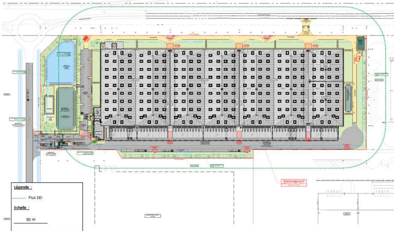
Figure 11 – Cartographie de la toxicité des fumées – projet VIRTUO FOS 1
